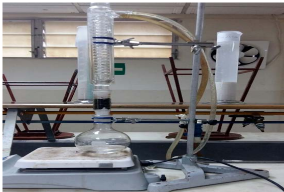
Figura 2. Sistema de extracción del aceite de la cáscara.
