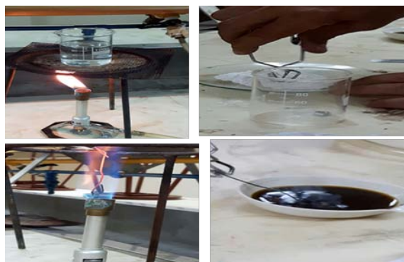
Figura 4. (a) Tuercas introducidas hasta hervir dentro de la solución de sosa cáustica (b) Cubrimos las tuercas con cal (c) Calentamos hasta el rojo vivo una de las tuercas (d) estando al rojo vivo se sumerge en el cardol.
