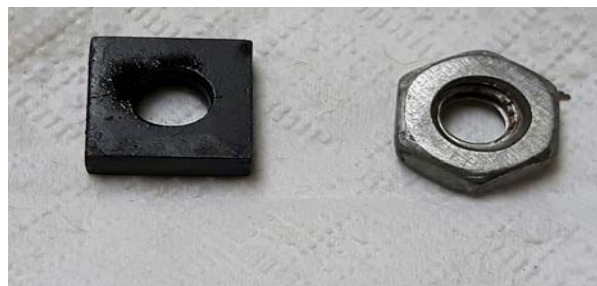
Figura 6. Pieza de la izquierda cubierta de aceite, tuerca de la derecha sin aceite.
