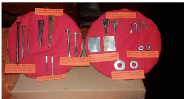
Figura 7. Piezas de metal resultantes luego de un mes en distintos medios corrosivos.
