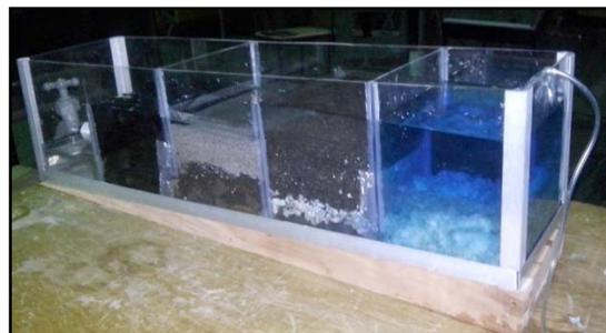
**Figura 3.** Filtración de agua con azul de metileno.
