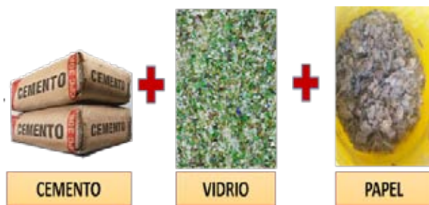
Figura 1. Materiales utilizados en la fabricación de los bloques bioamigables (cemento, vidrio molido, papel periódico humedecido).
