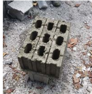
Figura 7. Proceso de curado; bloques a la intemperie.
