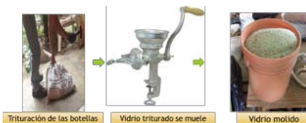
Figura 3. Proceso de trituración y molienda de las botellas de vidrio.
