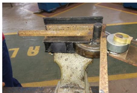
Figura 4. Imagen de la dobladora, doblando barras de acero liso de sección transversal cuadrada.
