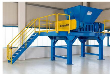
**Figura 5.** Tritradora, capacidad 3.5-4 ton/h. **Fuente:** [www.unoreciclaje.com](http://www.unoreciclaje.com).
