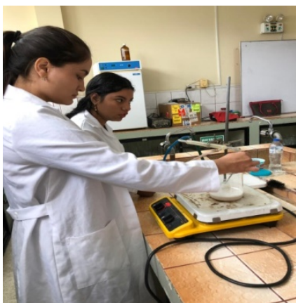
Figura 2. Evaporación del agua en la grasa del coco.
