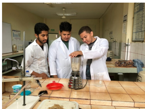
Figura 1. Reducción de partícula de la pulpa coco.
