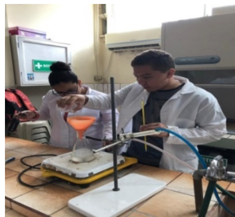
Figura 3. Vertido de metóxido y aceite en kitasato. Fuente: Autor
