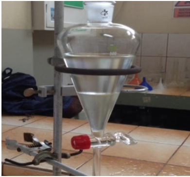
Figura 4. Productos formados en el embudo de decantación.
