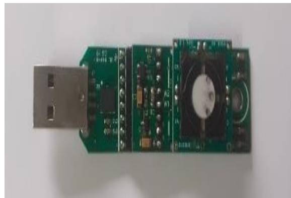
Figura 2. Sensor digital de dióxido de nitrógeno marca sensors SPEC [9].
