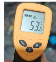
Figura 10. Medición de temperatura en el disipador del MOSFET después de 10 minutos.
