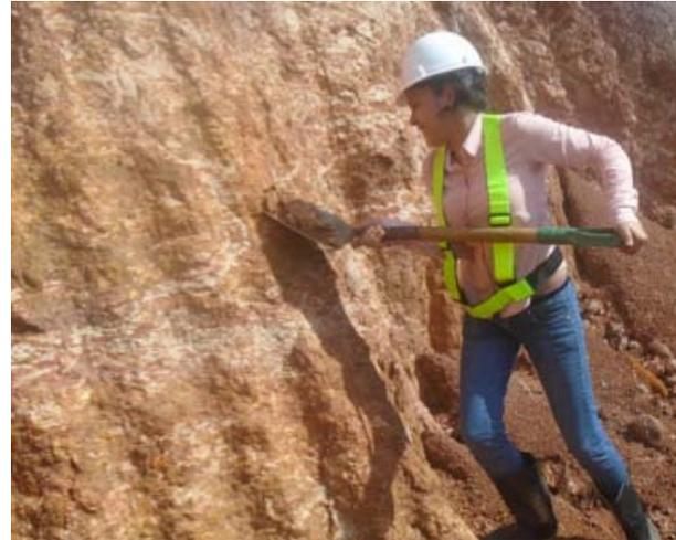
Figura 7. Recolección de muestra para ensayo de Proctor.
