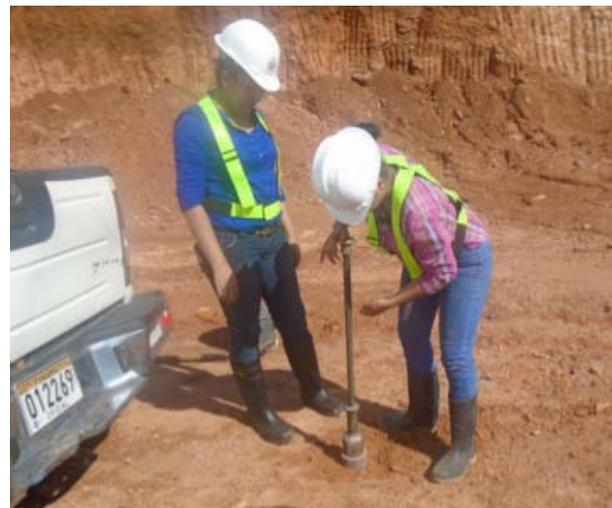
Figura 8. Muestreo con cilindros para determinar la densidad de campo.
