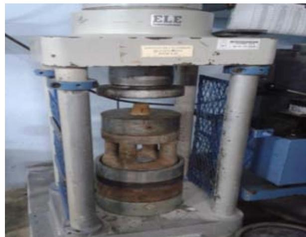
Figura 1. Máquina de compresión.
