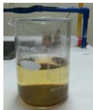
Figura 6. Muestra de agua de la procesadora cárnica tratada con tanino de la Musa Paradisiaca.
