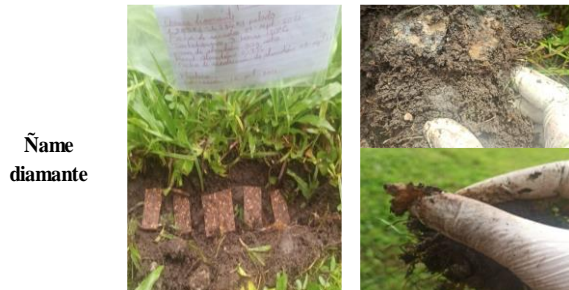
Figura 13 ensayo de biodegradación mediante siembra. Intervalo de 15 días con biopolímero de ñame diamante.
