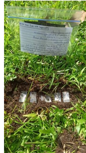
Figura 6 Ensayo de biodegradación en sembrado, con la descripción del biopolímero sembrado arriba.
