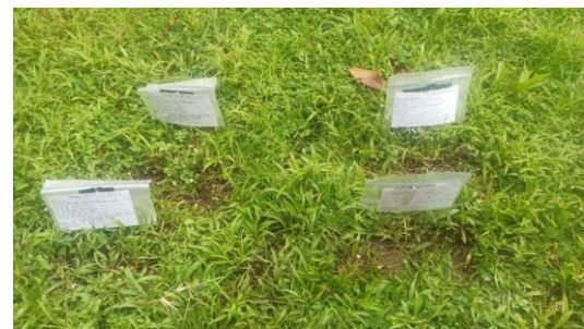
Figura 7 Biopolímeros enterrados para el ensayo de 15 días.
