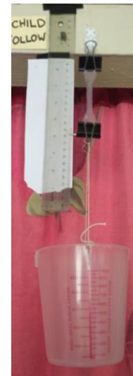
Figura 3 Ensayo de tensión casero empleado para los ensayos de tensión de los biopolímeros.
