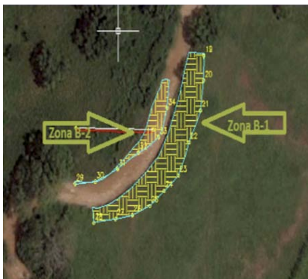
Figura 4: Vista de las Zona B-1 y B-2 y la superficie erosionada.
