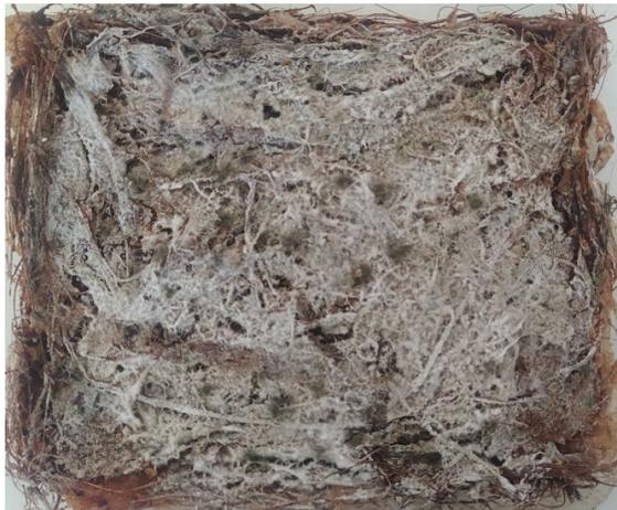
**Figura 11.** Lámina de estopa de coco, pegamento de arroz y sal gruesa, transcurrido 11 meses de su fabricación.
