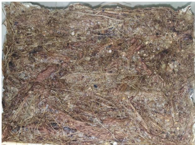
**Figura 4.** Resultado final de la lámina de estopa de coco, pegamento de arroz y sílica gel.
