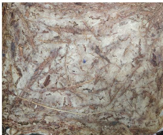
**Figura 3.** Resultado final de la lámina de estopa de coco, pegamento de arroz y sal gruesa.
