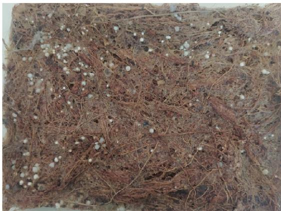
**Figura 12.** Lámina de estopa de coco, pegamento de arroz y sílica gel, transcurrido 11 meses de su fabricación.**Tabla 5.** Comparación de pesos de la lámina 1 correspondiente a la experiencia 4
