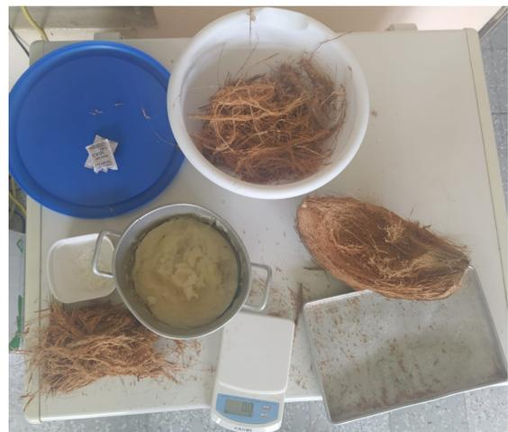
Figura 1. Materiales utilizados para la fabricación de las láminas.
