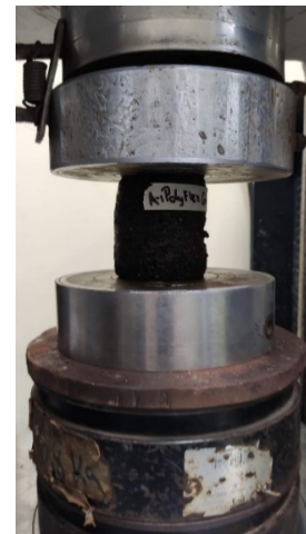
Figura 4. Probeta A1 durante el ensayo de compresión.
