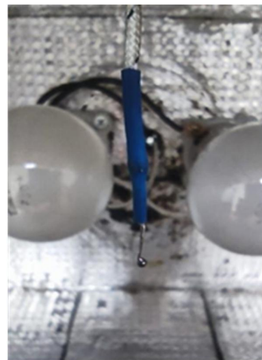
Figura 3. Sonda termopar colocada en el interior de la caja.
