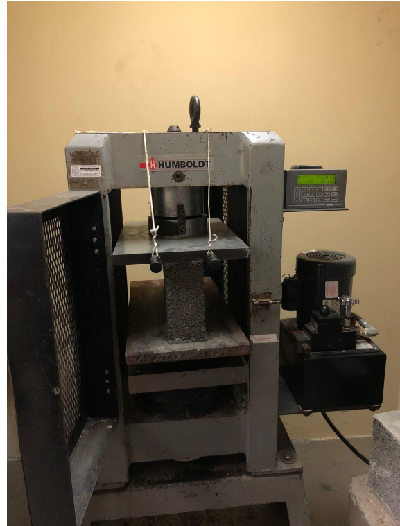
Figura 5. Bloque expuesto a prueba a compresión.
