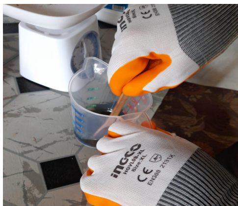
Figura 11. Realizando mezcla de resina de poliéster con catalizador.
