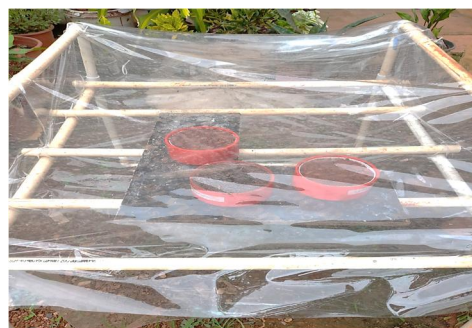
Figura 13. Probetas en sus respectivos moldes, secando en invernadero construido.
