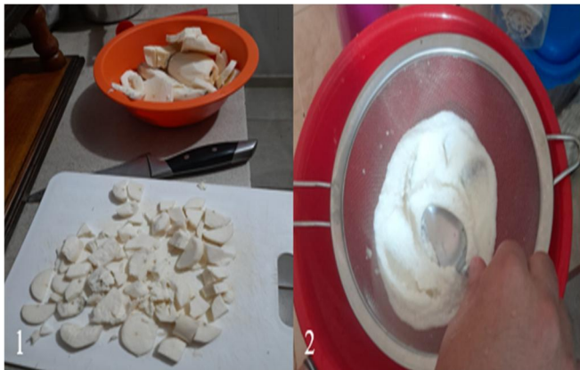
Figura 8. Yuca descortezada y recortada para elaborar aglomerante (1), Filtrado de almidón yuca (2).
