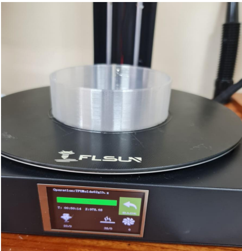
Figura 5. Molde de TPU en impresora FLSUN. Impresión 3D realizadas en FABLAB-UTP Azuero.
