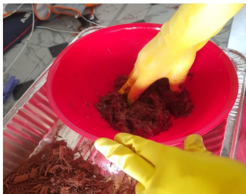
Figura 12. Mezclando fibra de coco con almidón de yuca.
