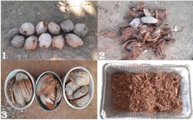
Figura 7. Proceso de selección (1), corte (2), limpieza (3), y trituración (4) de la fibra de coco.
