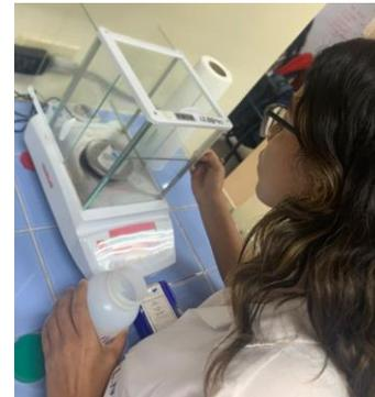
Figura 3. Pesa de muestra de  $CuSO_4 \cdot 5H_2O$  en el Laboratorio de Sanitarias.
