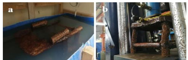
Figura 4. Pruebas de validación del prototipo. a. Prueba de flotabilidad. b. Prueba de deformación.
