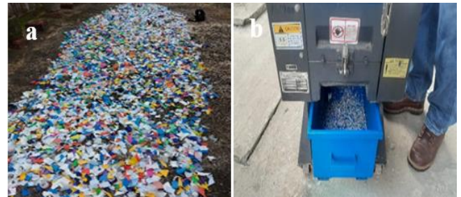
Figura 2. Proceso de elaboración del prototipo. a. Secado del HDPE. b. Trituración del HDPE.
