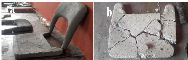
Figura 5. Prototipos de cemento y yeso con plástico HDPE triturado. a. Piezas del prototipo de cemento. b. Prototipo de yeso fracturado.
