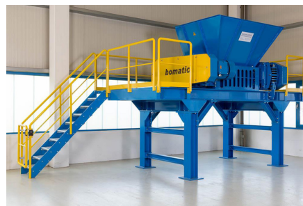
Figura 5. Tritradora, capacidad 3.5-4 ton/h. Fuente: www.unoreciclaje.com .
