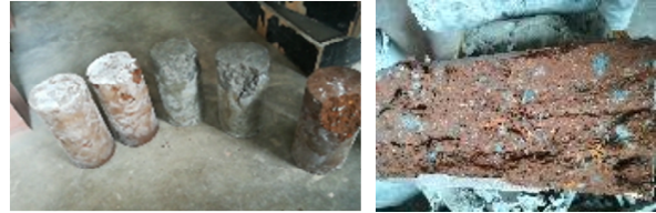
a) Fallas en los cilindros
