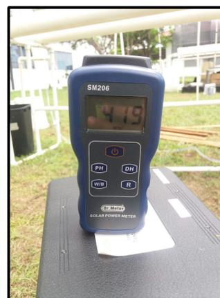
**Figura 2.** Imagen que muestra la medición de la radiación solar de 419 W/m<sup>2</sup>, utilizando un medidor de potencia solar Dr. Meter, modelo SM206.
