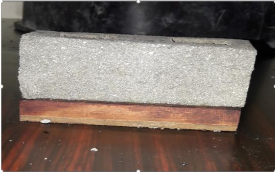
Figura 4. Bloque de caliche de pared a 25%.
