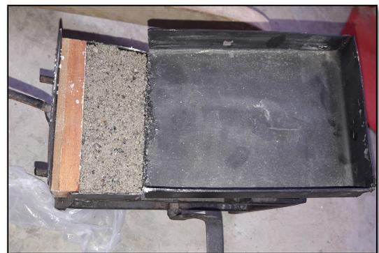
Figura 3. Mini máquina de fabricación de bloques casera.
