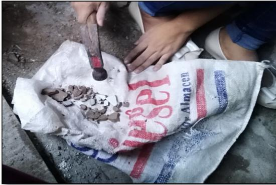
Figura 1. Trituración del caliche de pared.
