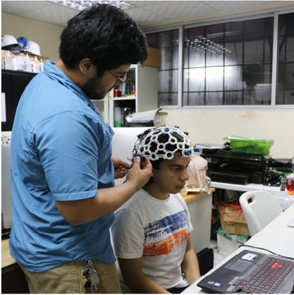
Figura 1. Calibración de los sensores EEG.
