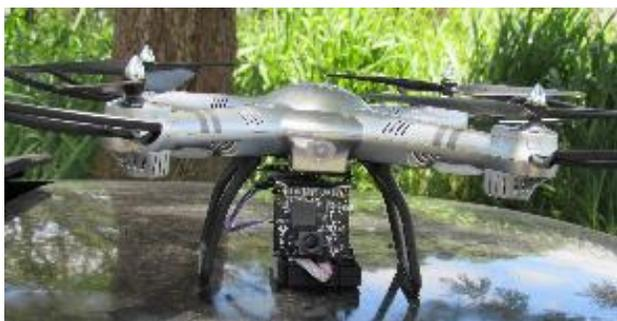
Figura 6. Drone implementado con el sensor PIXY CMUCAM5.
