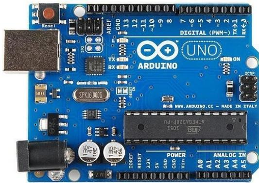
Figura 2. Controlador del sistema; Instrumento Arduino.
