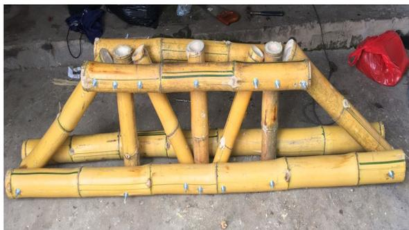
Figura 4. Prototipo de cercha final.
