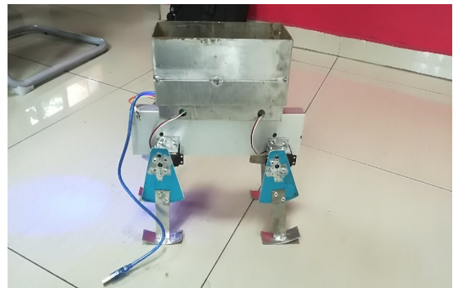
Figura 11. Prototipo del robot finalizado demostrando su estabilidad y utilidad para el transporte de objetos domésticos.
