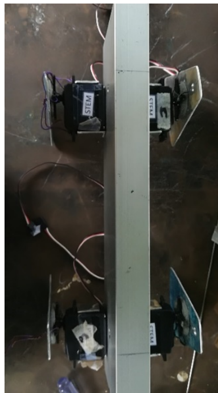
Figura 2. Las piezas impresas en 3D unidas a la estructura de aluminio.
