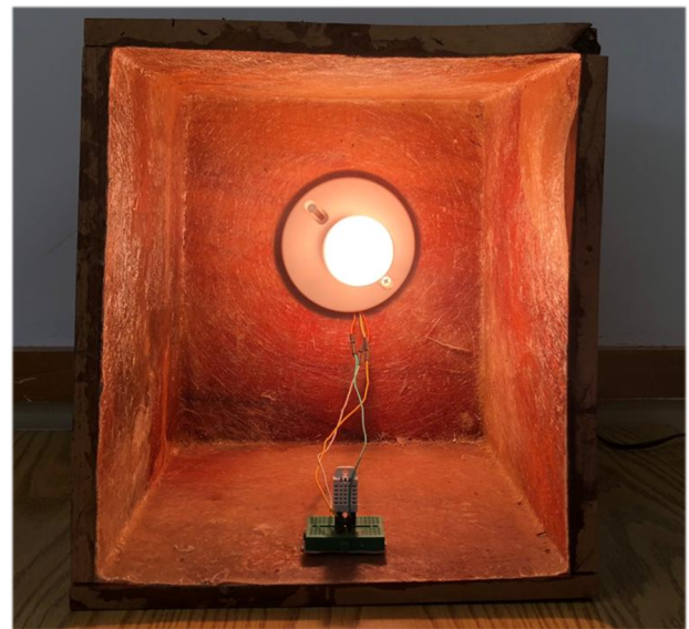
Figura 1. Medidor experimental de conductividad térmica.
