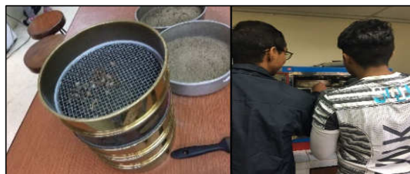
Figura 7. Procedimiento del tamizado y secado de la muestra.
