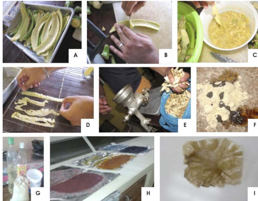
Figura 1. Composición fotográfica de las diferentes etapas y procesos en la elaboración del bioplástico: (a) cáscaras de plátano; (b) raspado del endocarpio de la cáscara; (c) inmersión de las tiras en la solución antipardeamiento; (d) tiras de endocarpio dispuestas para el secado; (e) molienda de las tiras secas; (f) prueba de yodo para detectar presencia de almidones; (g) materiales para la elaboración de bioplásticos; (h) disposición del bioplástico húmedo sobre una superficie; (i) bioplástico obtenido.
