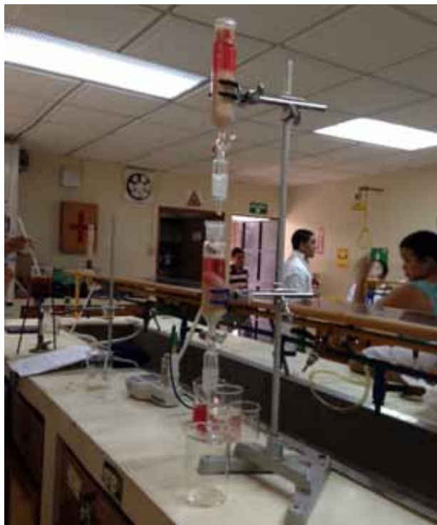
Figura 6. Disposición de biofiltros en serie para el tratamiento de efluentes con pigmentos orgánicos de origen animal.
