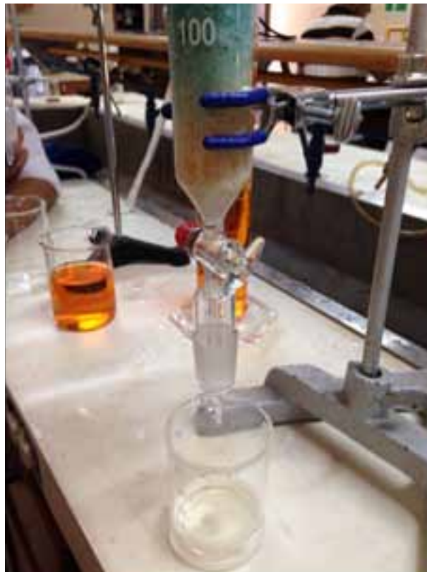
Figura 7. Tratamiento de efluente con azul de metileno.
