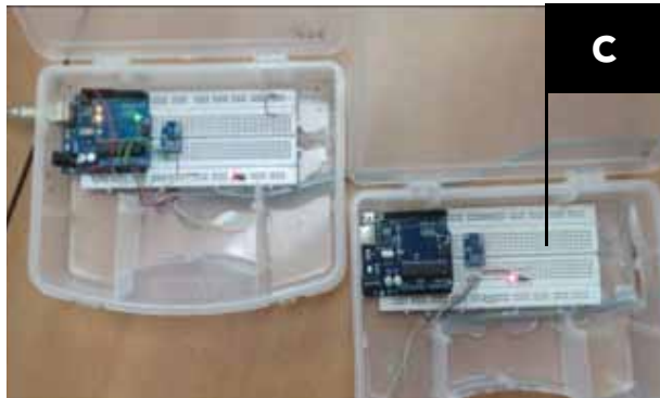
Figura 2. Sistema EDMO, la placa protoboard se usa como soporte de los sensores acelerómetros. (C: Placa protoboard).
