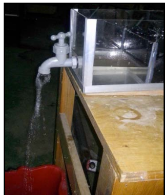
Figura 4. Agua filtrada, luego de pasar cada cámara.
