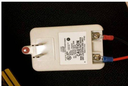
Figura 11. Transformador utilizado para alimentar la cerradura electrónica.
