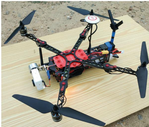
Figura 13. Armazón o estructura tipo X.
