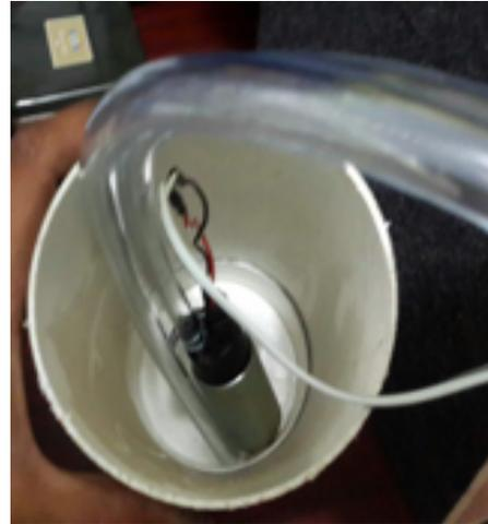
Figura 2. Bomba y reservorio de agua residual.
