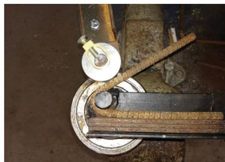
Figura 3. Imagen de la dobladora, doblando barras de acero corrugado.
