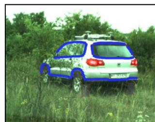
**Figura 5.** Seguimiento visual de objetos. Seguimiento monocromático del vehículo 3-D basado en modelos en un entorno no estructurado relacionado con oclusiones parciales [20].
