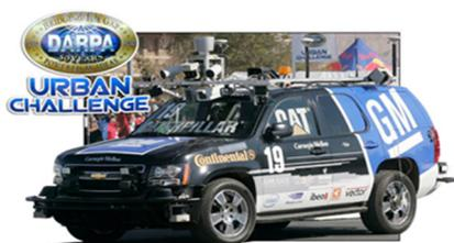
**Figura 2.** En DARPA Urban Challenge 2007, seis vehículos terminaron la carrera. Esta imagen muestra a "BOSS" (Tartan Racing Team, Carnegie Mellon University, primer lugar). Los sensores en los techos de estos autos son casi los mismos: LIDAR, cámaras y antenas de GPS [27].
