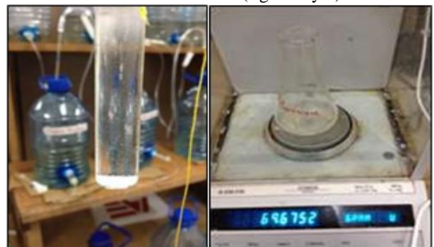
Figura 5 y 6. Pruebas de respirometría (izquierda) y sólidos suspendidos (derecha).
