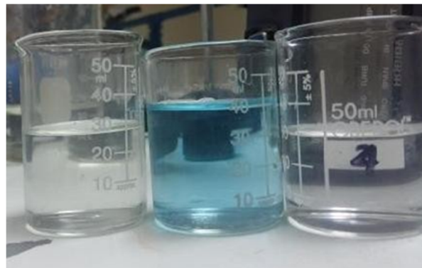
Figura 8. Muestra de efluente sin tratar y tratado con las biomasa de las cáscaras de la naranja.
