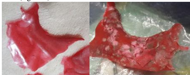
Figura 3. Crecimiento microbiano sobre el bioplástico, evidencia de biodegradación.
