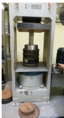
Figura 4. Aplicación de carga en una probeta.
