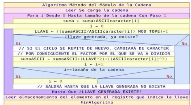
Figura 5. Diagrama de Nassi-Shneiderman del Método del Módulo de la Cadena.
