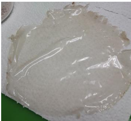
Figura 2. Apariencia de los bioplásticos con plastificante.
