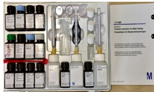
Figura 2. Laboratorio compacto MColortestTM (1.11151.001).
