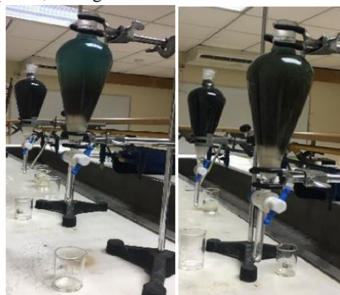
Figura 7. Sistema de filtración utilizado en los ensayos de bioadsorción.
