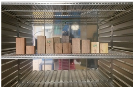
Figura 3. Probetas en el horno. (Laboratorio de Suelos y Materiales, Universidad Tecnológica de Panamá, Centro Regional de Coclé).
