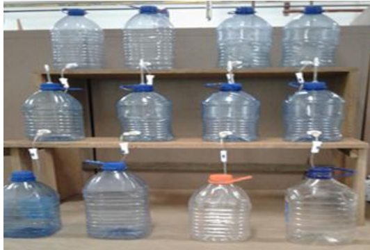
Figura 4. Sistema de biorremediación en forma de escala, en donde caerán a favor de la gravedad el flujo de nutrientes de un escalón a otro.
