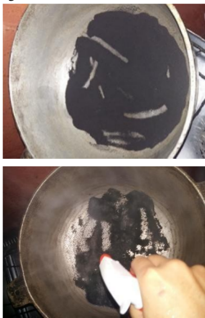
Figura 5. Muestra de biomasa carbonizada y de su activación térmica.
