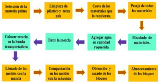
Figura 2. Diagrama del proceso de fabricación de bloques ecológicos.
