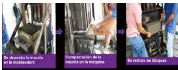
Figura 6. Compactación de la mezcla.
