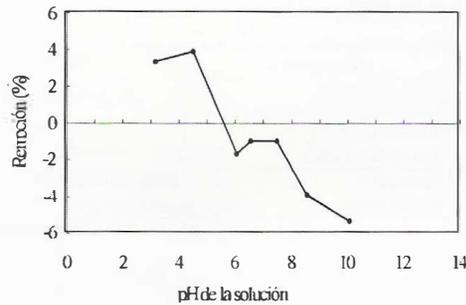
**Figura 1. Efecto del pH en la absorción del fenol por el SBCM**
