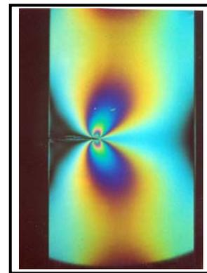
**Fig. 1. Campo de esfuerzos observado en una placa con una grieta lateral.**
