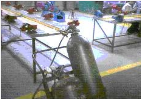
Figura 2. Equipo Oxiacetilénico utilizado en los ensayos de templado.
