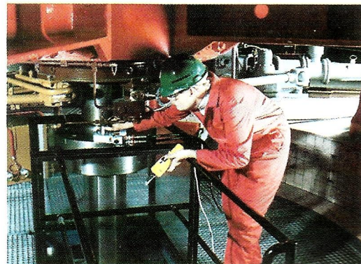
El control remoto colgante hace la operación más segura, más conveniente y más económica, ya que un solo operador puede realizar la labor de torsión.
