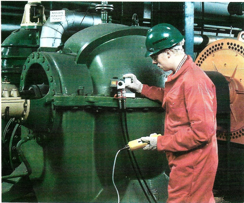
El sistema LT, con palanca de reacción y cubo, es compacto, liviano y fácil de operar.
