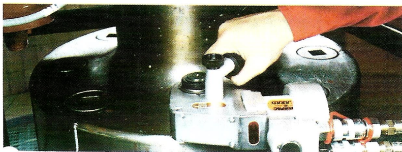
El sistema UKS con cabeza de trinquete RV y cubi cuadrado, provee una torsión precisa para las juntas empernadas de este eje de generador.
