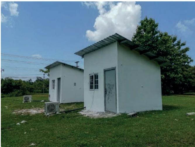
Ilustración 1. Recinto de pruebas, ubicado en Tocumen. El primero, sin aislamiento térmico; el segundo, con aislamiento térmico.
