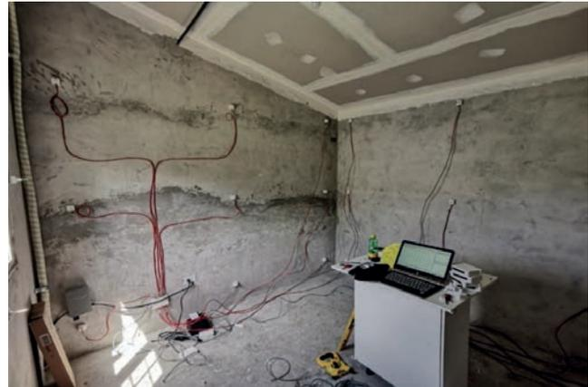
Ilustración 2. Parte inferior de un recinto de prueba en el que se observa el sistema de captación de datos de temperatura.
