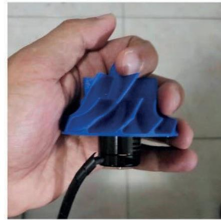
Impresiones en 3D de ventilador mecánico
